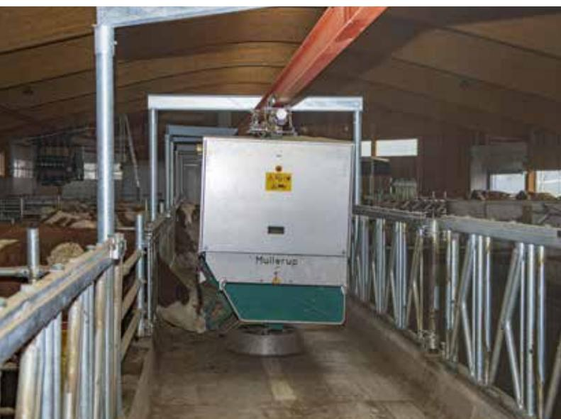
Fütterungsroboter "MixFeeder" bei der Arbeit
